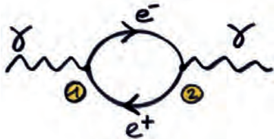
Figure 2 : un photon ( \gamma ) se désintègre, en ①, en une paire virtuelle électron-positron ( e^- - e^+ ), laquelle s'annihile en ② pour redonner un photon.
